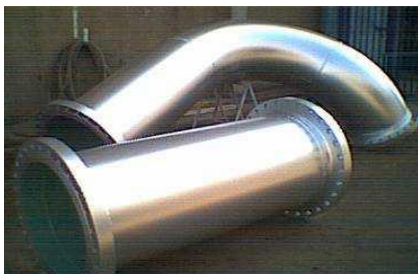
Billede 7: Rustfrie rør coatet med Chesterton komposittype S2 på offshore installationer hos Petrobras i Brasilien.
