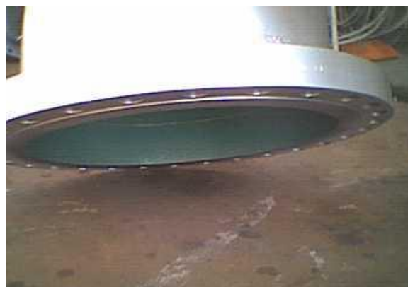
Billede 7: Rustfrie rør coatet med Chesterton komposittype S2 på offshore installationer hos Petrobras i Brasilien.
